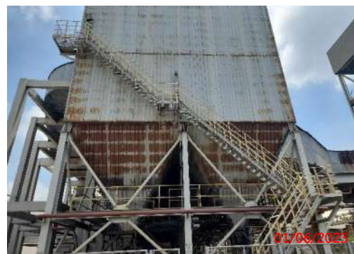
รูปที่ 2-10 ระบบดักจับฝุ่นแบบถุงกรอง (Bag Filter)
